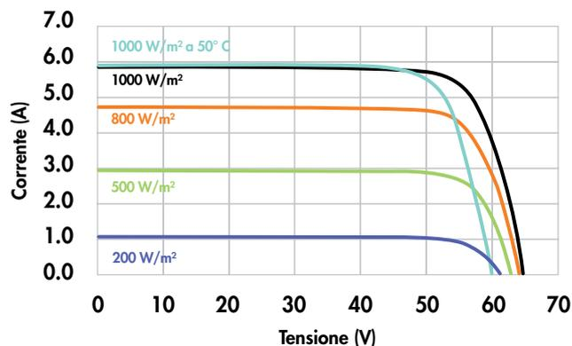
Caratteristiche di corrente/tensione a seconda dell'irraggiamento e della temperatura del modulo.
